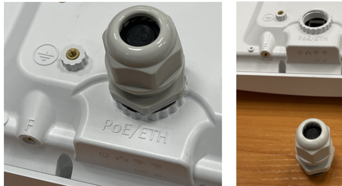
Рисунок 12 – Снятие кабельного ввода
