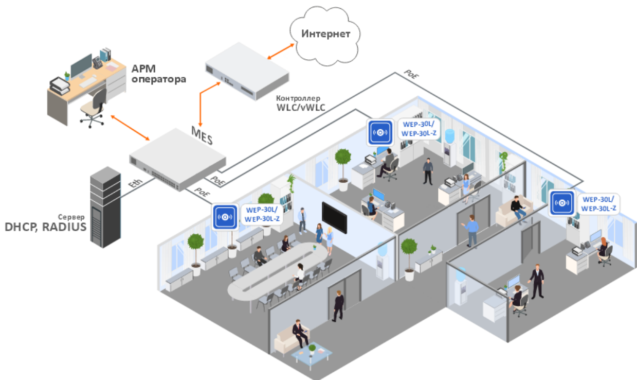
Рисунок 1 — Функциональная схема использования WEP-30L/WEP-30L-Z
