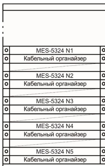
Рисунок 46 — Размещение коммутаторов MES5324 в стойке
