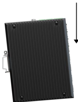
Рисунок 47 — Первый этап инсталляции MES на DIN-рейку
